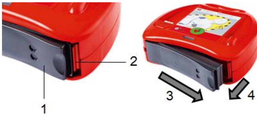
Fig. 6 Desmontaje del módulo de energía
